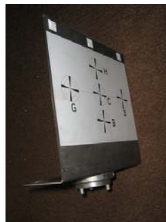
Figure 2 : Équerre avec huit cibles dont trois rétro réfléchissantes
