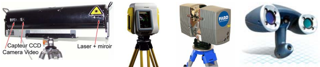
Figure 1 : de gauche à droite, scanner à mesure par triangulation, scanner à mesure de temps de vol (Trimble GX), scanner à mesure de différence de phase (Faro LS), scanner à repérage de position.
