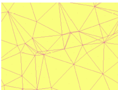
Figure 4 : MNT fait à partir du semis avec les routes comme lignes de force
