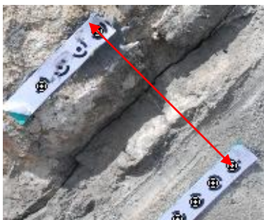
Figure 7, Figure 8 et Figure 9 : Mesure de déplacement sur un modèle 3D d'une fissure et sur un fissuromètre, et la visualisation de la différence de MNT sous AutoCAD.
