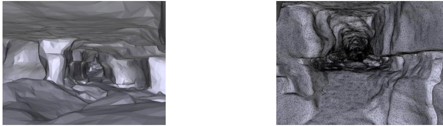
Figure 4. Modèles 3D maillés (densité de 1 point/centimètre) Secteur 13 (à gauche) et secteur 18 (à droite)
