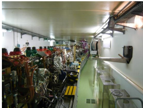
Photo 1 : succession des différents aimants constituant le tunnel du Storage Ring
