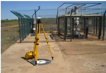
Figure 4 : LiDAR boards mesurées au GPS
