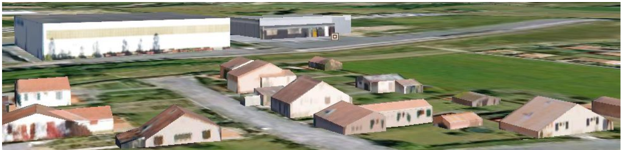
Figure 3 : Textures appliquées avec le logiciel RhinoTerrain à partir de données multi-caméra du GPSO
