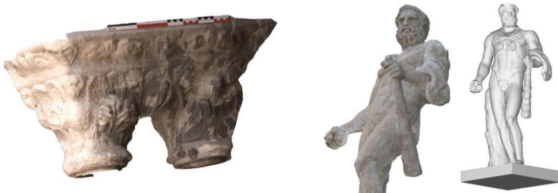
Figure 3– Nuage de points d'un chapiteau du cloître de Saint Trophime (gauche) – Nuage de points de la statue d'Hercule (milieu) – Modèle maillé de la statue d'Hercule (droite)
