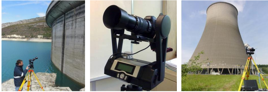
Figure 4 : Appareil photo monté sur la tête panoramique
