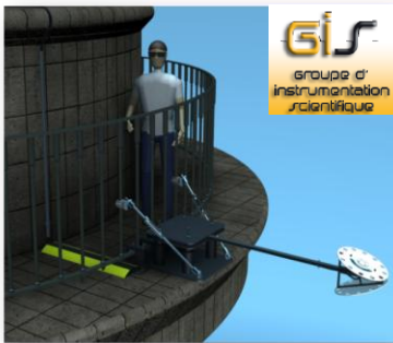
Figure 3.5 – Système de fixation du réflectomètre sur le phare de Cordouan
