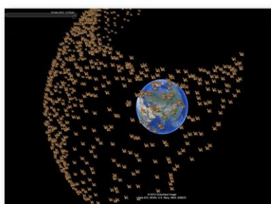
Figure 3.2 – Visualisation de la position des satellites GPS « visibles » du phare de Cordouan, sur 24h avec un pas d'échantillonnage de 15 minutes
