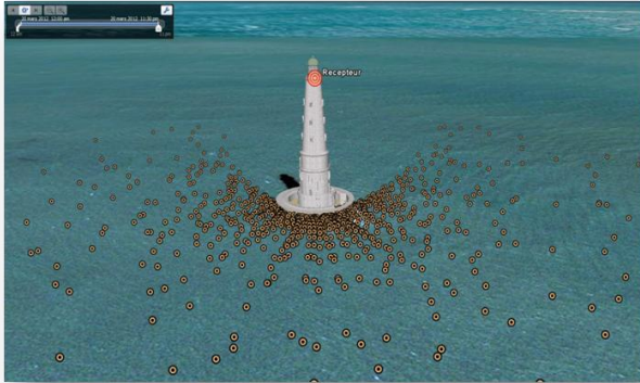
Figure 3.3 – Position des points de réflexion théoriques Simulation sur le phare de Cordouan (durée : 24h, pas : 15')
